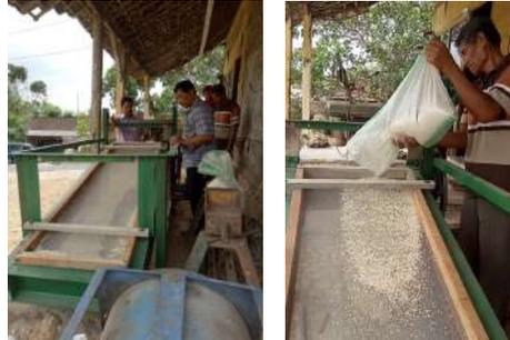
**Gambar 12.** Uji coba operasional mesin ayak getar tipe excentric
