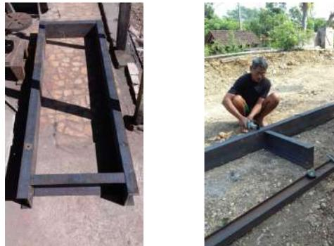
**Gambar 8.** Proses pembuatan rangka ruang ayakan
