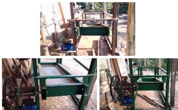
**Gambar 10.** Merangkai komponen mesin ayak getar tipe excentric
