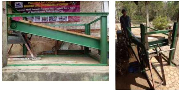
**Gambar 11.** Mesin ayak getar tipe excentric yang sudah jadi.
